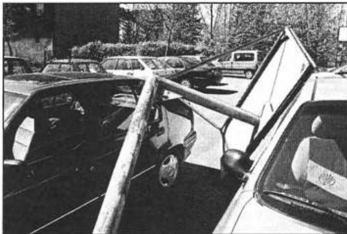
3 maja tablica do koszykówki na parkingu za kościołem św. Klemensa podczas silnych podmuchów wiatru spadła na zaparkowane samochody. Złamała się przrzedziwiała podpora. W samochodach tablica powygięła karoserie. Fot. W. Suchta
