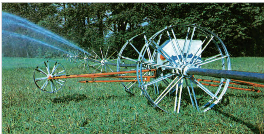
Jeden ze sztandarowych wyrobów „Meprozetu” – rurociąg przetaczany N 609 „Wisła”, przeznaczony do deszczowania upraw polowych i warzywnych.
